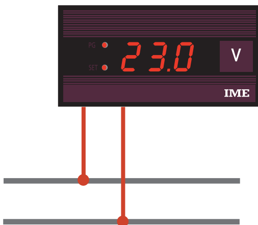
Direkteingang 100(120)V Direct Input 100(120)V
